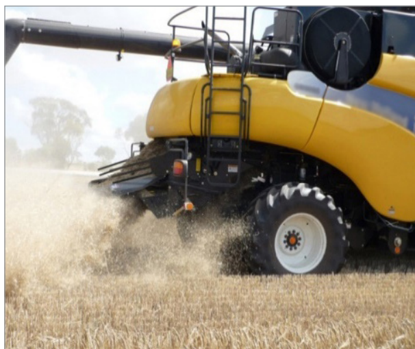
شکل ۱۸- انهدام بذر علف‌های هرز با اتصال ادوات خردکننده به دنباله کمباین
